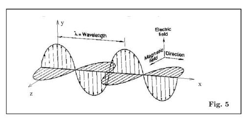
Se x è l'asse di propagazione, e (x,y), (x,z) sono i piani di polarizzazione del campo elettrico  $\boldsymbol{E}=(E_x,E_y,E_z)$  e magnetico  $\boldsymbol{H}=(H_x,H_y,H_z)$  rispettivamente, allora le loro componenti sono
