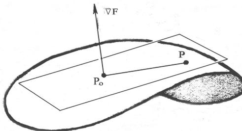
Fig. 6.7 - Piano tangente ad una superficie in un punto  $P_0$ .
