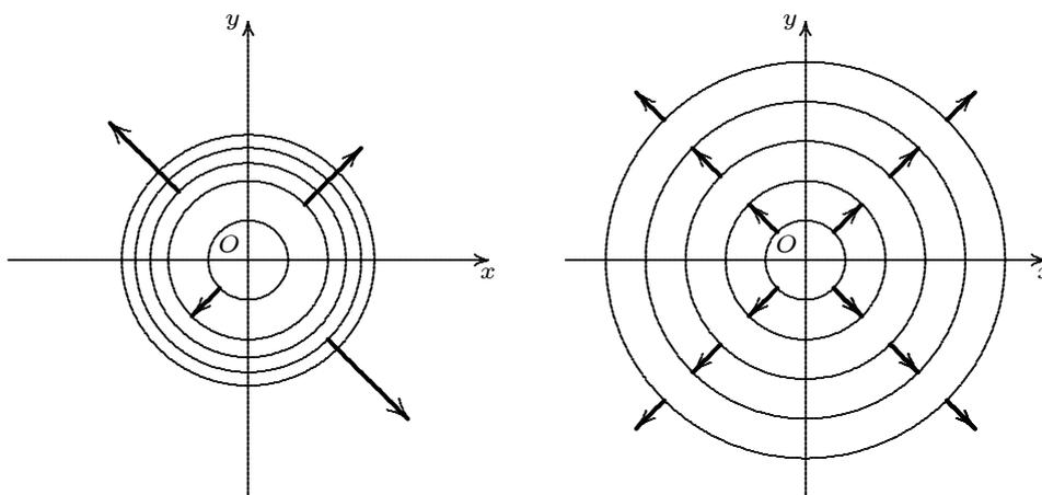
Fig. 6.6 - Gradienti delle funzioni  $f(x, y) = \frac{1}{2}(x^2 + y^2)$  e  $g(x, y) = \sqrt{x^2 + y^2}$  e curve di livello per  $c = 1, 2, 3, 4, 5$ .
